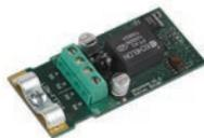
Опция является преобразователем внутреннего протокола контроллера в открытый протокол Modbus, используемый в системе комплексного управления и диспетчеризации здания.
