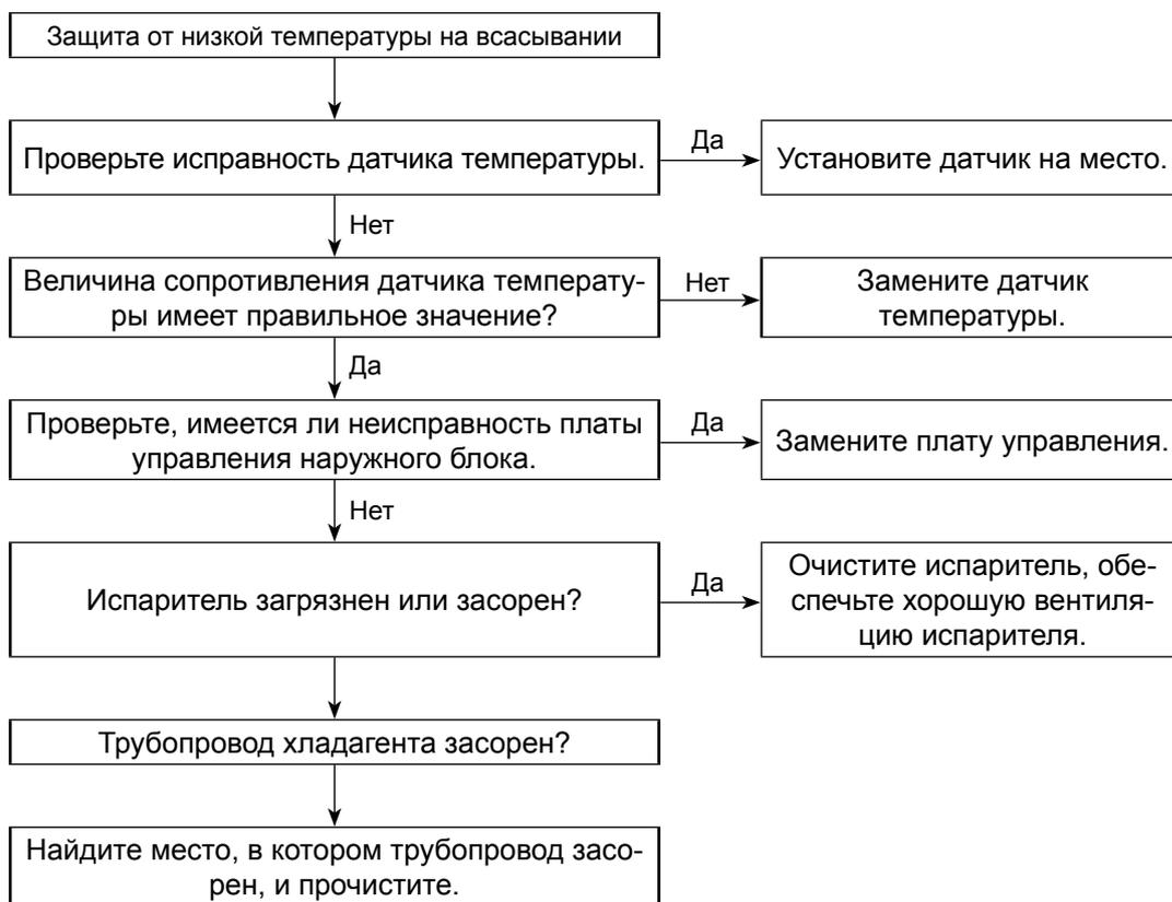
**Неисправность датчика температуры на всасывании**
