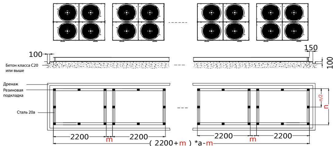
2. Схема бетонного основания
