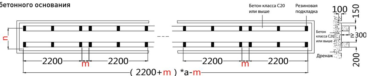
Цифры ниже указывают на площадь установки комбинации модульных агрегатов серии SCAW-M.
