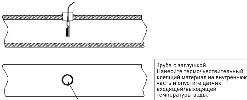
Труба с заглушкой. Нанесите термочувствительный клеящий материал на внутреннюю часть и опустите датчик входящей/выходящей температуры воды.
