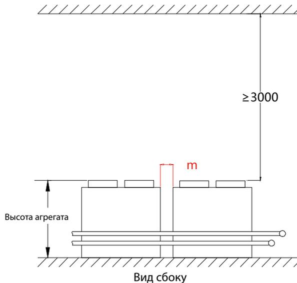
Цифры ниже указывают на площадь установки агрегатов серии SCAW-M.
