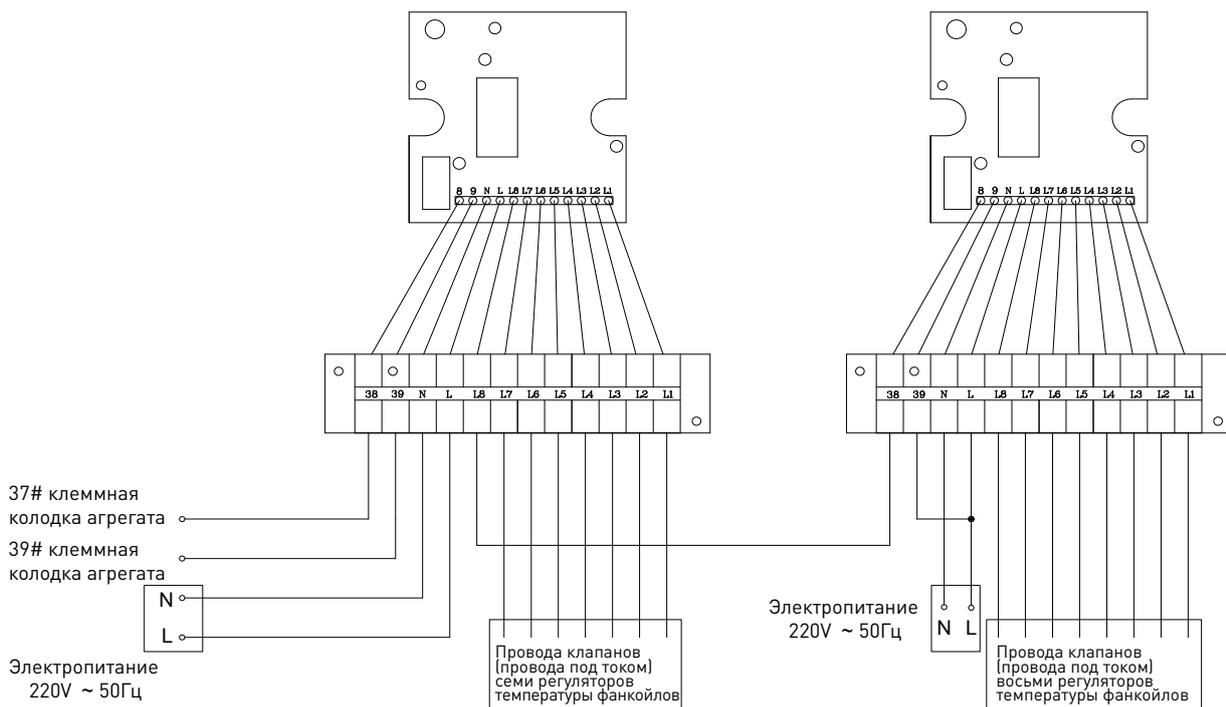
На изображении выше приведена электрическая схема подключения двух и нескольких блокировочных контроллеров.
