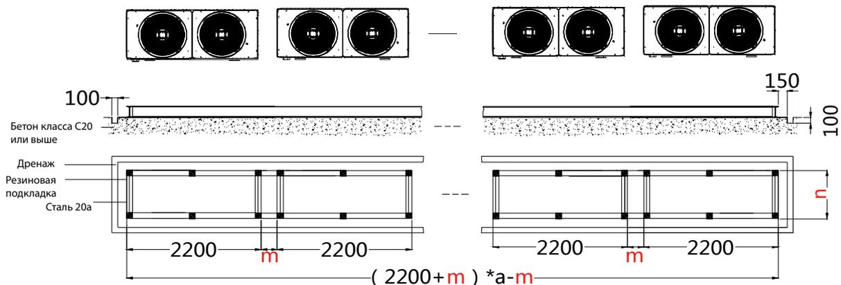
2. Схема бетонного основания
