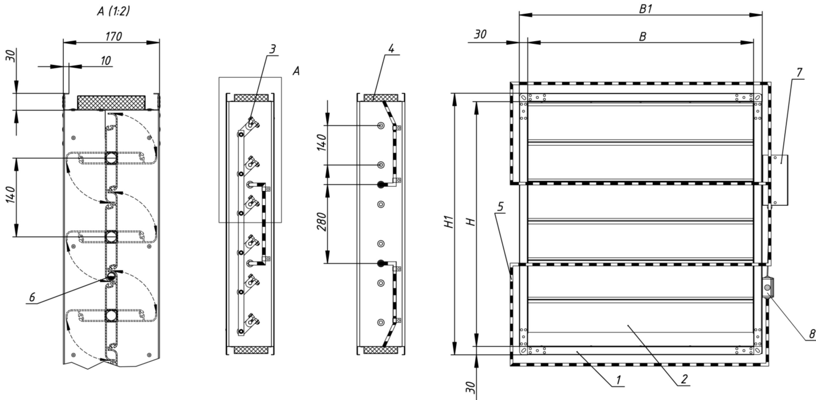
1 - Корпус; 2 - лопатка; 3 - рычаги и тяги; 4 - теплоизоляция; 5 - саморегулирующийся нагревательный кабель; 6 - тоннель для электронагревательного кабеля; 7 - электропривод; 8 - распаячная коробка.
