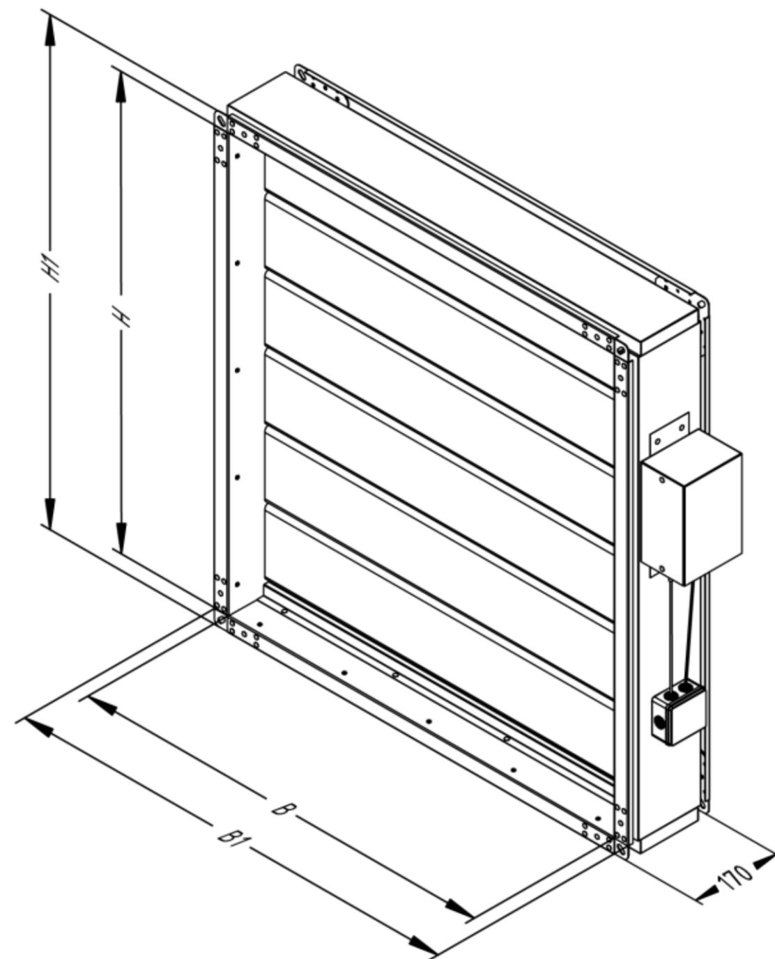
*Клапаны КВУ могут изготавливаться только прямоугольного сечения, для перехода с прямоугольного на круглое сечение в комплект допускается установка перехода на фланцевом или ниппельном соединении на соответствующий диаметр.*
