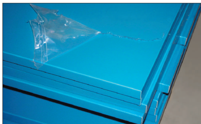
Панели с покрытием с защитной пленкой
