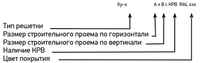
**ПРИМЕР:** 1) Вр-Р2 300x150 с КРВ RAL9016 - вентиляционная решетка с индивидуально регулируемыми горизонтально расположенными жалюзи и условными размерами 300 мм по горизонтали и 150 мм по вертикали, с наличием клапана расхода воздуха КРВ, цвет решетки по каталогу RAL9016.
