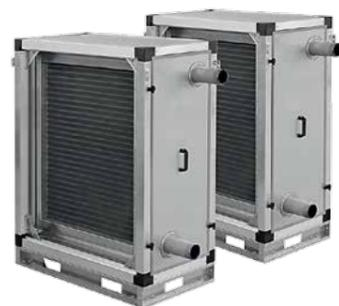
Секции рекуператора с промежуточным теплоносителем представлены 8 типоразмерами. Система рекуперации представляет собой схему передачи теплоты вытяжного воздуха приточному с помощью двух жидкостных теплообменников, находящихся в вытяжной и приточной камерах. КПД рекуперации достигает 50%.
