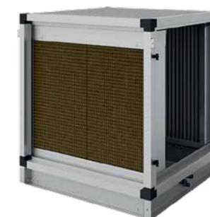
Секции представлены 8 типоразмерами и предназначены для адиабатического увлажнения воздуха циркуляционной водой, поступающей из поддона. Высокая эффективность (КПД до 95%) достигается за счет большой площади испарения воды с поверхности сот. Номинальная эффективность увлажнения: 85% и 95%.
