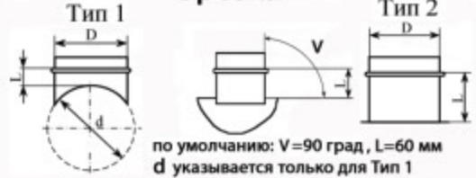
Врезка(Кр) - Тип - D - (d) - (L) - (V)
