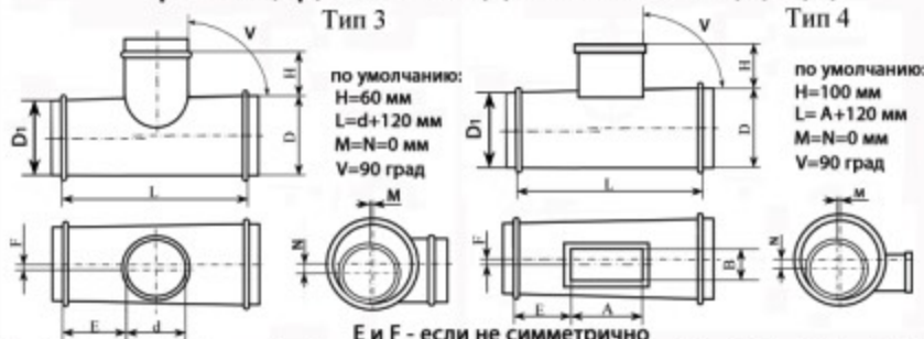
Тройник(Кр) - Тип - DxD1 - (L) - (MxN) - d или А x В - (H) - (V) - (ExF)
